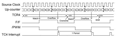
Fig. 27. Timing Chart for PWM Mode
